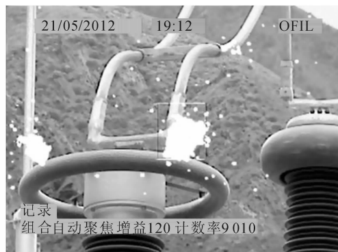
图中方框为1号主变500 kV侧C相进线CVT均压环;增益为120;测试距离为19.09 m;光子计数为9 010。
