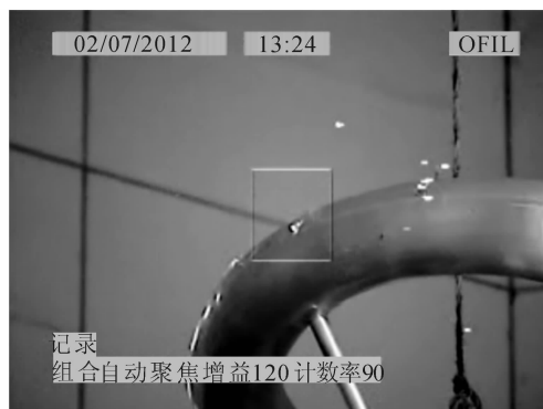
图中方框为未涂金属杂质的透明胶带; 增益为120; 测试距离为16 m; 光子数为90。
