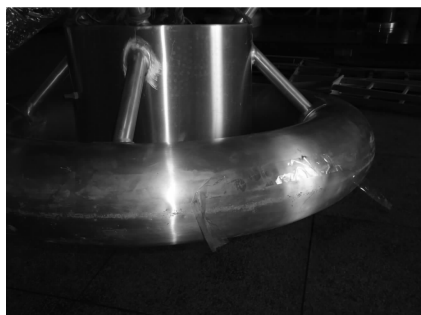
图6 模拟色漆起皮用的附着有金属微粒的透明胶带
