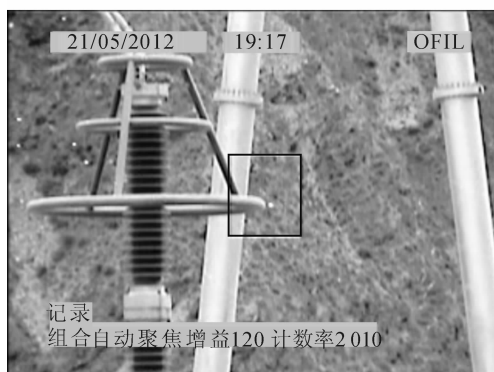
图中方框为毛色线出线C相避雷器均压环; 增益为120; 测试距离为35.89 m; 光子数为2010。
