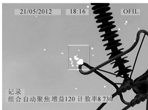
图中方框为色茂一线B相进线构架V型串均压环;增益为120;测试距离为28.92 m;光子计数为8 730。
